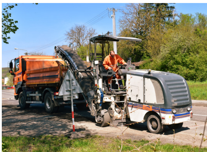
Fréza Wirtgen DC 50, šířka 50 cm
