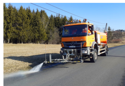
Mytí komunikací kropicím vozem
