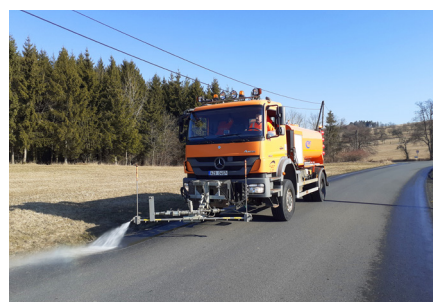
Mytí komunikací kropicím vozem
